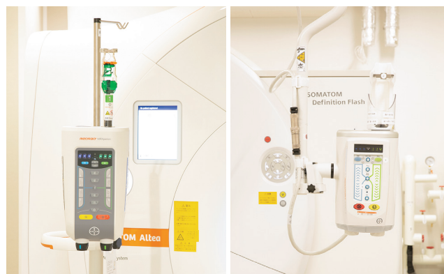
図1 両インジェクタのヘッドパネル(左: MRXperion、右: Stellant)
