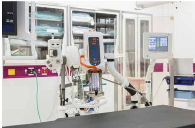
図2 Mark 7 Arterion。チューブをつけたままで前面からシリンジの取り外しが可能となったのが特長。
